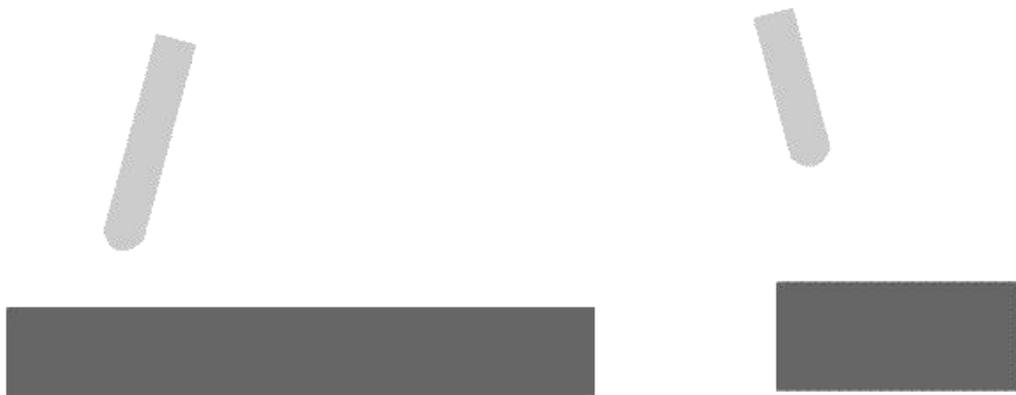
③运条 运条一般分为三个基本运动：沿焊条中心线向熔池送进，沿焊接方向均匀移动，横向摆动。上述三个动作不能机械地分开，而应相互协调，才能焊出满意的焊缝。
