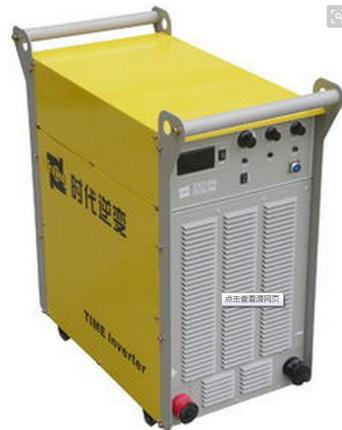
脉冲弧焊电源 焊接电流以低频调制脉冲方式馈送，一般由普通的弧焊电源与脉冲发生电路组成。它具有效率高、输入线能量较小、线能量调节范围宽等优点。它**主要**用于**气体保护电弧焊**。
